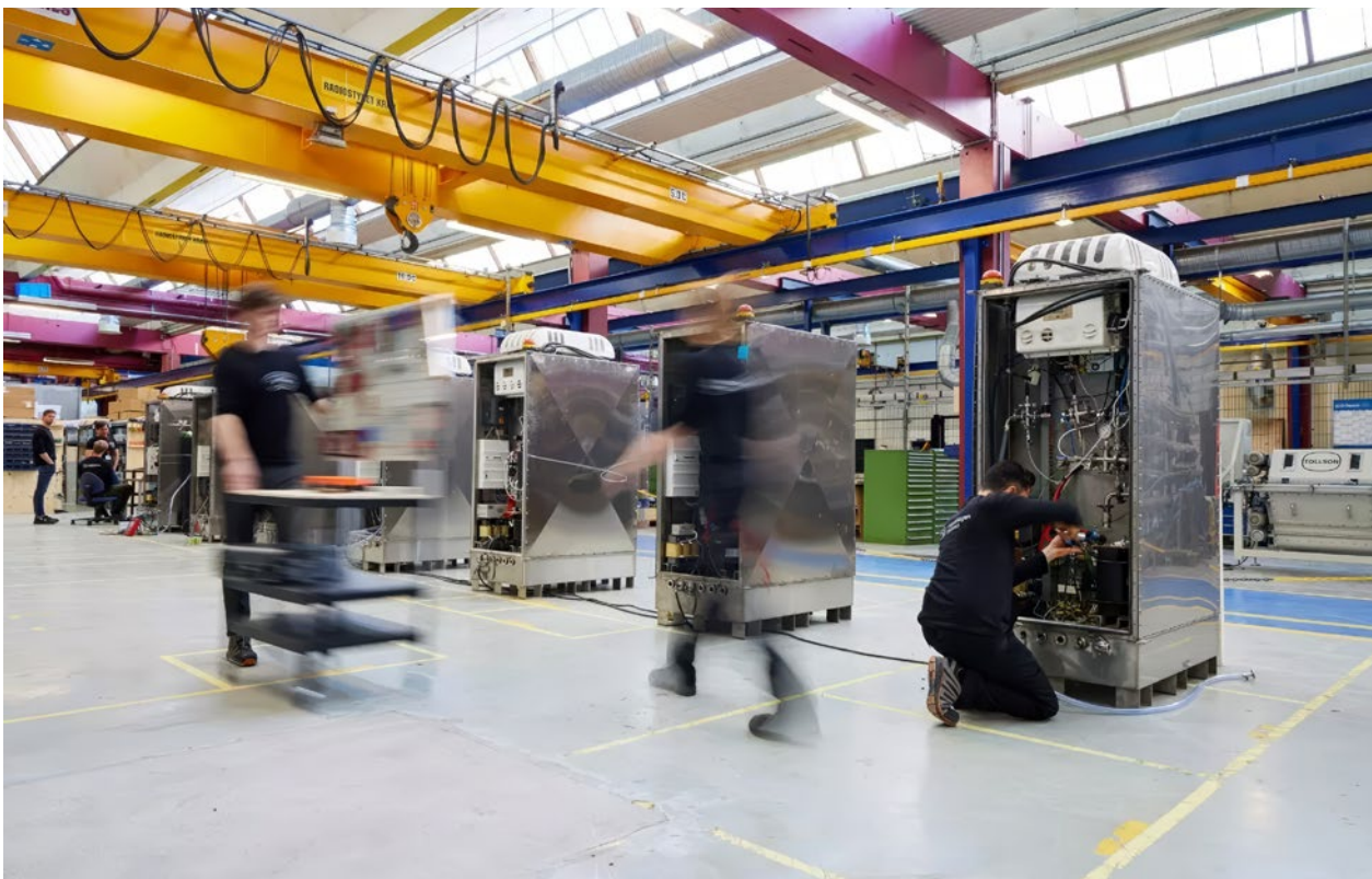
Copenhagen Atomics stellt Salzkreisläufe her, um diese für Materialtests einzusetzen, aber auch um sie an Kunden zu verkaufen und so Einnahmen zu generieren. (Foto: Copenhagen Atomics)
