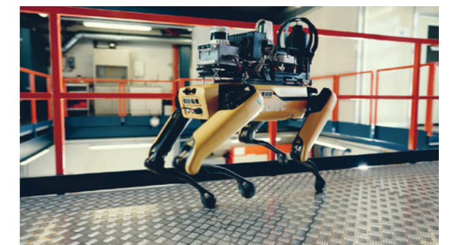
Strahlenschutz mit Hightech: Der Roboter Spot geht für Menschen in Bereiche mit hoher Dosisleistung. (Foto: Axpo)
