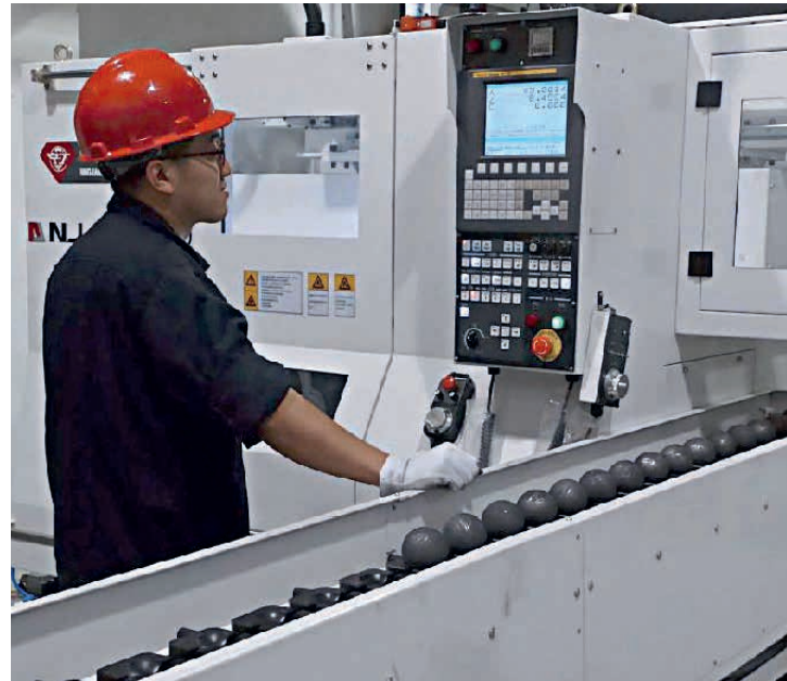
Kommerzielle Brennstoffkugelfabrik in Baotou, Innere Mongolei, mit einer Produktionskapazität von 300'000 Kugeln pro Jahr. (Foto: CNEC)
